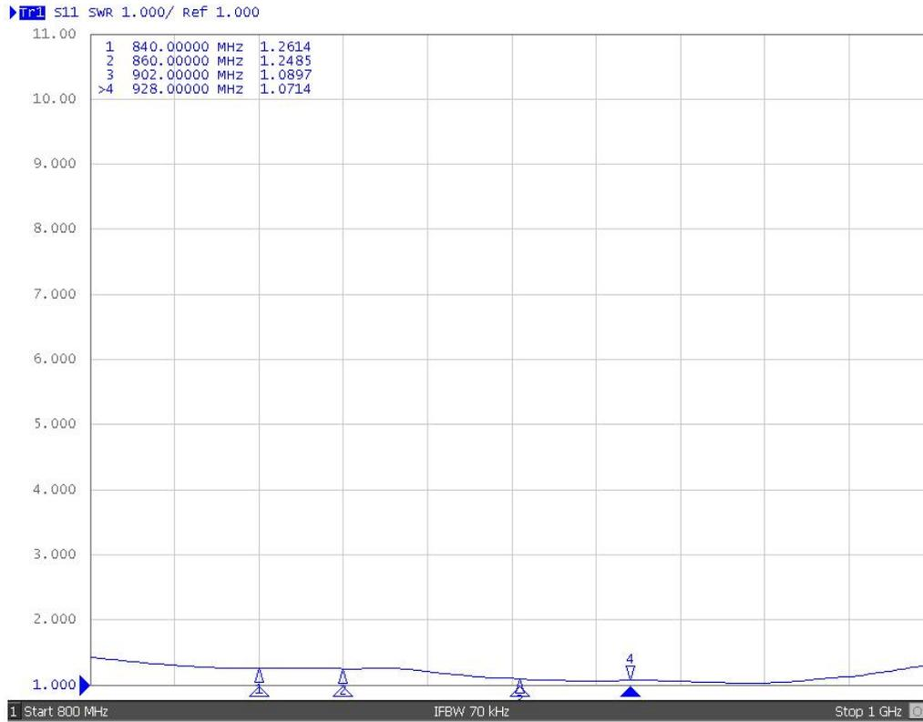
图6 BRA-02型天线驻波比测试图
