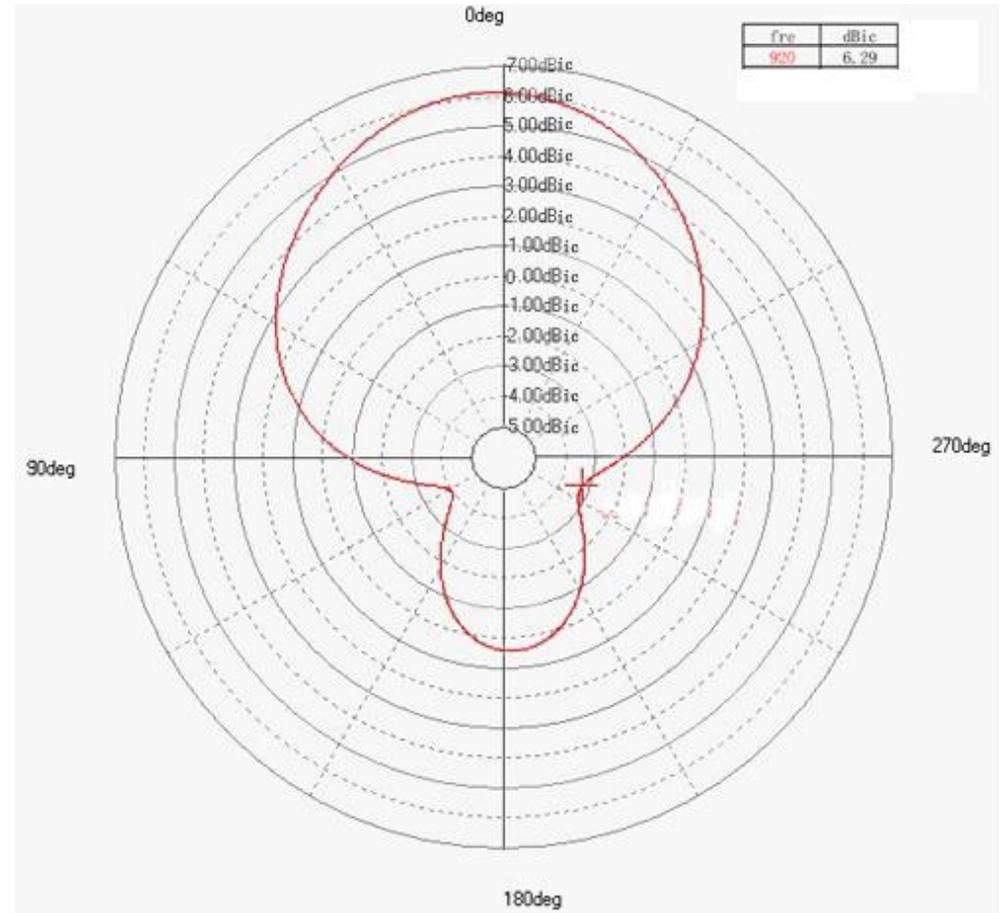
图7 BRA-02型天线方向图（二维方向图，增益显示大于6 dBic）
