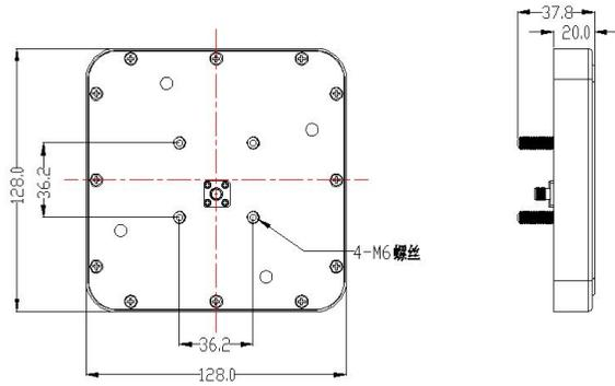
图2 安装尺寸图
